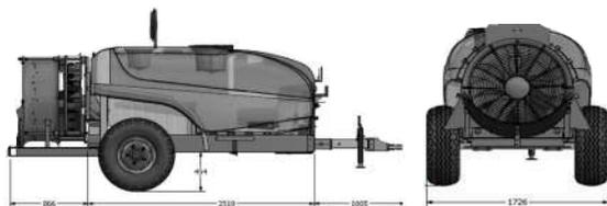
El atomizador TORNADO 2000 es un equipo diseñado para la aplicación fitosanitaria de árboles frutales. Cuenta con un sistema de ventilación axial que permite dirigir gotas finas y penetrar el producto hasta el tronco del árbol. Cuenta con tanque de 2000 litros de capacidad; equipada con un robusto chasis.
